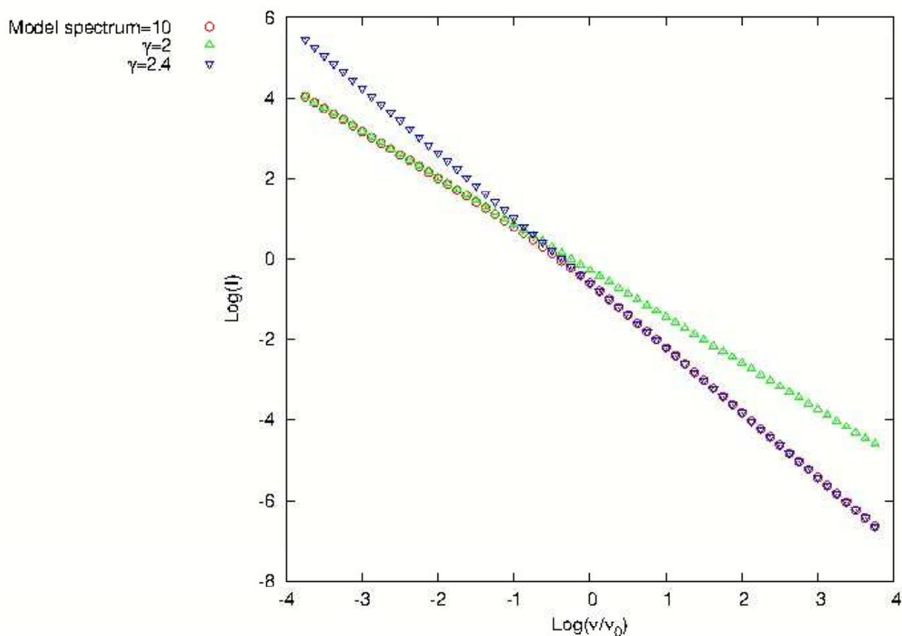
Рисунок 5.3 — Частотный спектр для модельного распределения с параметром  $\Omega = 10$ , при угле между линией наблюдения и джетом,  $\theta = 10$ , а также для степенных распределений с показателем  $-\gamma$ . При малых частотах спектр модельного распределения неотличим от степенного распределения с показателем -2.
